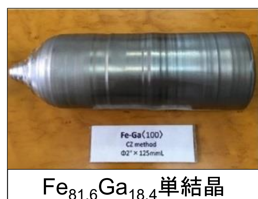
Fe 81.6 Ga 18.4 単結晶 近年開発された安価で磁歪効果の大きい磁歪材料
